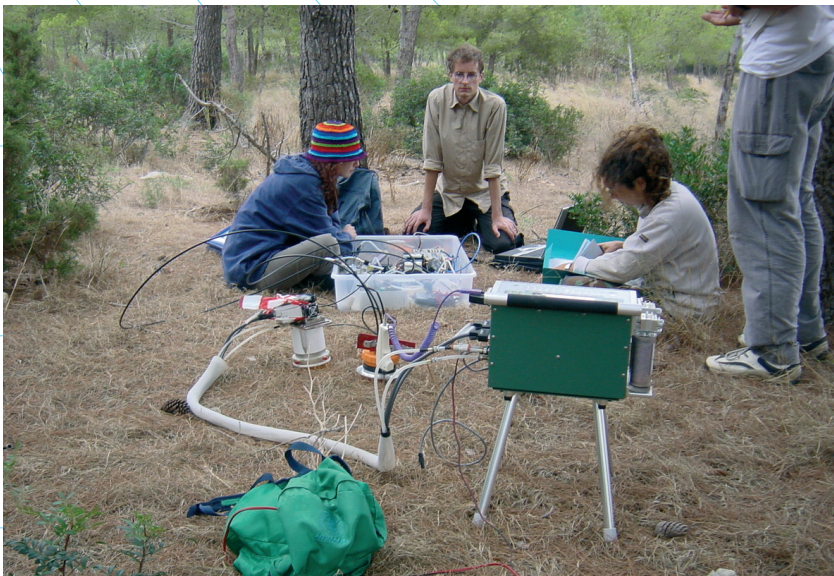
Wussten Sie, dass der Boden atmet? Mit dieser „Bodenkammer“ messen wir, wie viel \text{CO}_2 vom Boden auf Pianosa freigesetzt wird.
