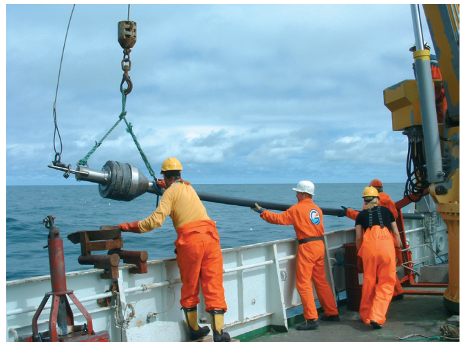
Einsatz des Schwerelots im Fahrwasser zwischen den Färöer und den Shetland-Inseln während der Expedition NO-Clim an Bord des Forschungsschiffes Hakon Mosby
