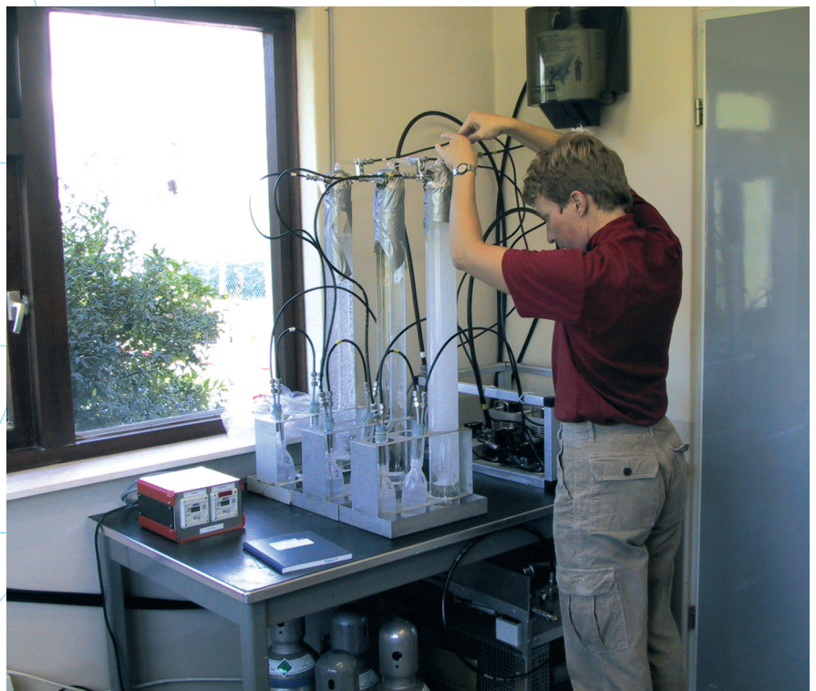
In der atmosphärischen Überwachungsstation Lutfjewad an der Nordseeküste (Niederlande) werden zweimal wöchentlich CO 2 -Proben genommen, wobei CO 2 in Natriumhydroxid gebunden wird.
