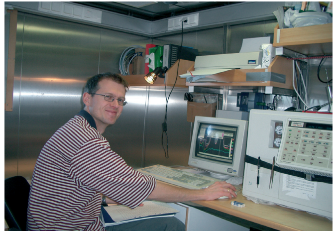
Anders Olsson bestimmt halogenierte Kohlenwasserstoffe im Meerwasser durch Gaschromatographie
