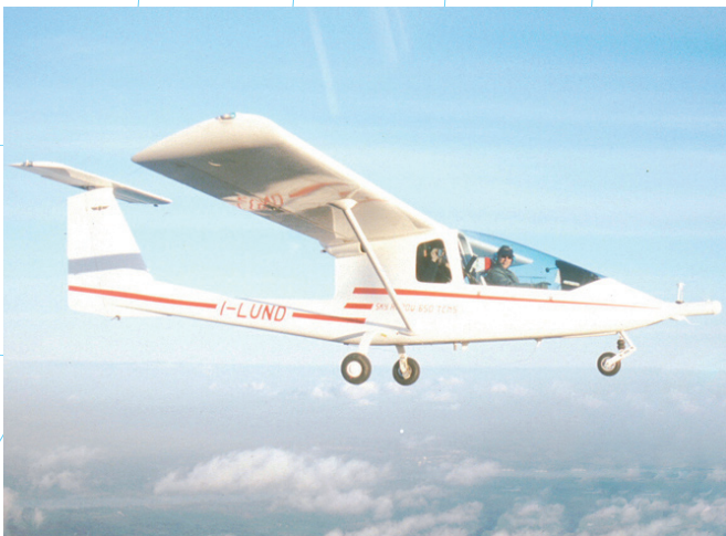
SkyArrow, das kleinste Forschungsflugzeug der Welt, misst die Flüsse von \text{CO}_2 und Wasserdampf.
