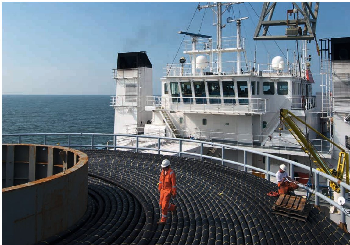
4.20 > Auch die Verlegung von Seekabeln, die mit großen Schiffen wie der „Team Oman“ auf den Meeresboden herabgelassen werden, muss bei der marinen Raumplanung berücksichtigt werden.
